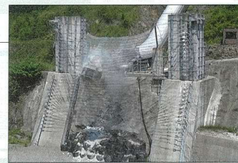
実規模実験状況(ネットタイプ_5,000kj)
