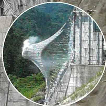
実験による性能検証の様子(ネットタイプ5,000kJ)
