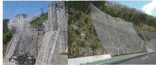
●実験による性能検証の様子 (ネットタイプ5,000kJ)
